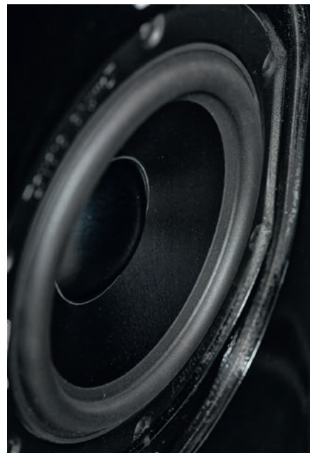
Dwie niskotonowe 18-ki zainstalowano na bocznych ściankach obudowy; również ich membrany są aluminiowe, ale są to głośniki innego typu, niż te pracujące w droższych Virgo 25 plus+ . Maskownice niskotonowych są „wciskane” i w normalnym użytkowaniu mają pozostać założone, stąd po ich zdjęciu widać mniej estetyczne wykończenie wyfrezowania obudowy, dzięki któremu jednak maskownica licuje z płaszczyzną ścianki.
