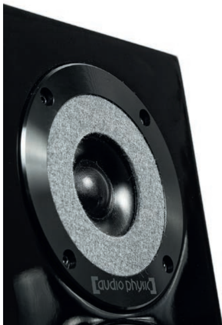
Nową (trzecią) wersję HHTC poznamy po szarym kolorze pierścienia wokół membrany; jest nią nie tylko jedwabna, jednocalowa kopułka w środku, ale przede wszystkim aluminiowy stożek. Konstrukcja i profil membrany są więc podobne jak w większych głośnikach średniotonowych i niskotonowych. Według konstruktorów firmy, kopułkowe głośniki wysokotonowe powinny odejść do historii, podobnie jak odeszły kopułkowe średniotonowe...
