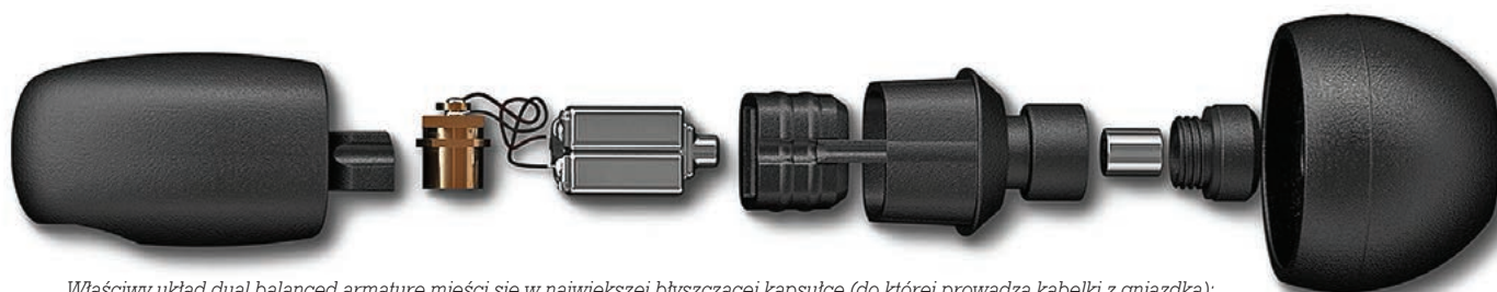
Właściwy układ dual balanced armature mieści się w największej błyszczącej kapsułce (do której prowadzą kabelki z gniazdka); na prawo od niej widać obudowę, mała błyszcząca tulejka to filtr akustyczny, na prawo od niego przedostatni element układanki - filtr mechaniczny, wreszcie wybrana przez nas wkładka.
