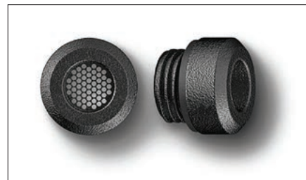
Filtr mechaniczny, czyli siateczka osłaniająca, zabezpieczając przed dostaniem się z zewnątrz obiektów większych niż... w kole o średnicy 2 mm (na zdjęciu czterokrotnie powiększenie) wykonano 55 sześciokątnych otworków. Filtr możemy sami odkręcić, aby go wyczyścić.
